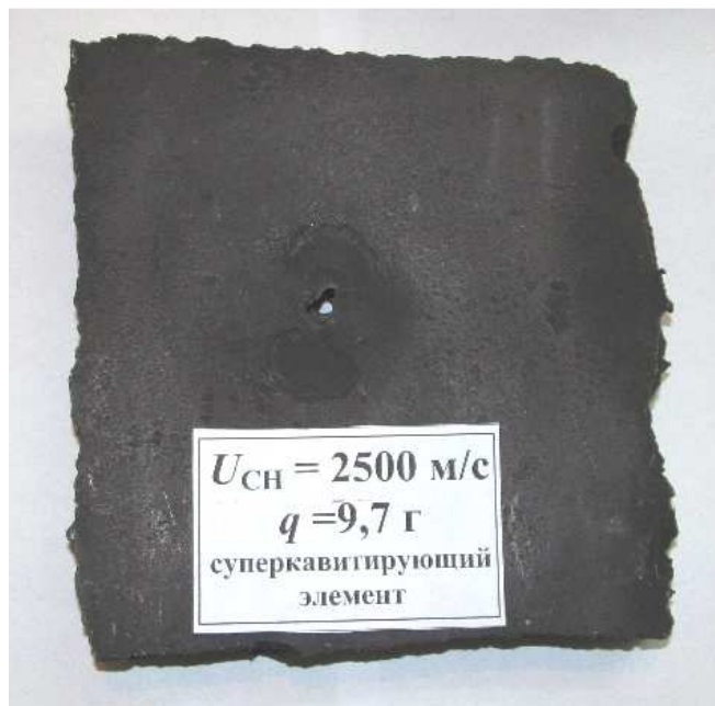
Рис.6. Вид лицевой поверхности бронеплиты после пробития.
